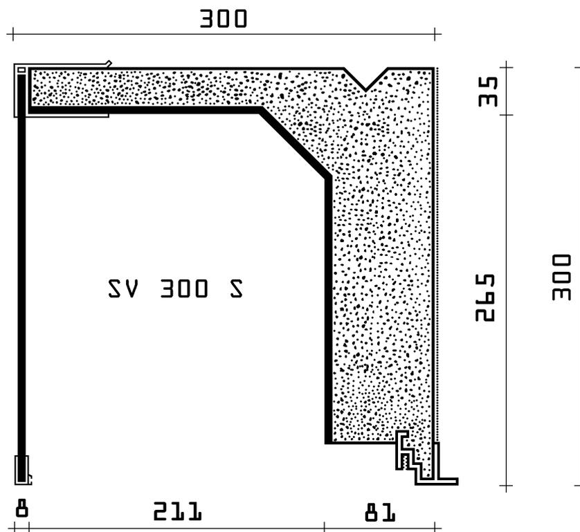
Serienmäßig haben alle Rolladenkästen der Typenreihe SV eine spezielle **Clip - Innenschiene** für den einfachen, schraublosen **EASY - CLIP - Deckelanschluss**, mit 15 mm Ausladung, sowie ein U-Profil als unterem Abschluss an der Außenschürze.
