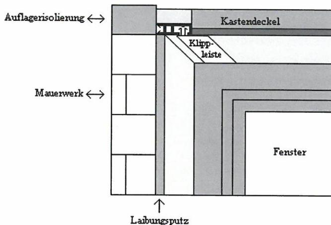
Das Laibungsputzabschlussprofil sitzt zwischen der Auflagerisolierung und dem Kastendeckel.
